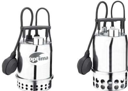
Electropompes submersibles pour eaux claires avec hydrauliques en acier inoxydable AISI 304 particulièrement appropriées pour les vidanges de puits, garages, caves ou locaux sujets à inondation. Également pour le relevage des eaux d'infiltration ou vidange d'eaux claires. Elles peuvent être utilisées dans des installations fixes ou mobiles. Équipées d'un câble d'alimentation de 10 m type H07 RN-F pour usage intérieur avec ou sans flotteur.
