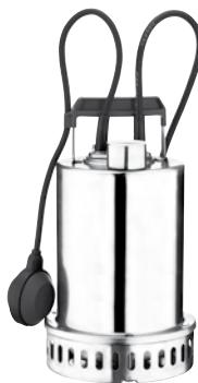
Electropompes submersibles en acier inoxydable AISI 304 particulièrement appropriées pour les vidanges de puits, garages, caves ou le drainage de chantiers de petites ou moyennes surfaces. Elles peuvent être utilisées dans des installations fixes ou mobiles. Équipées d'un câble d'alimentation de 10 m type H07 RN-F pour usage intérieur, avec ou sans flotteur.
