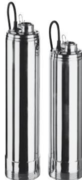
Electropompes centrifuges multicellulaires immergées de 5 pouces particulièrement appropriées pour le relevage d'eau propre de puits, citernes et réservoirs de première récolte. Également pour la pressurisation d'installations domestiques, la petite irrigation, le lavage de véhicules, et l'augmentation de pression en général. Dotées de double garniture mécanique avec chambre à huile interposée ainsi que de câbles d'alimentation de 20 m type H07 RN-F.
